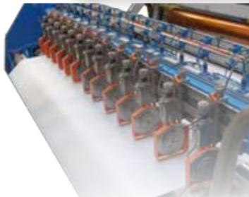
Sección robusta, exenta de vibraciones, dotada de una geometría basada en nuestra experiencia, que nos permite asegurar una separación óptima entre cortes.
